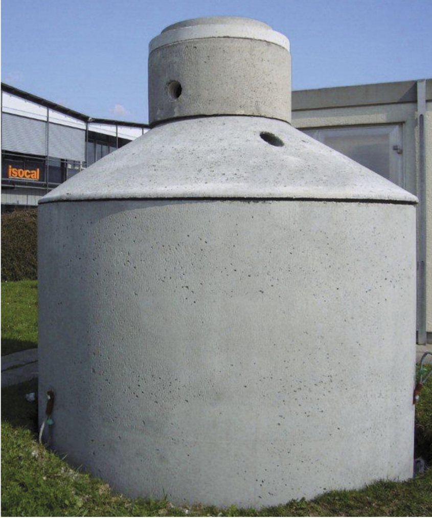
10 m 3 su hacmine sahip buz depolama tankı ve tank içerisindeki ısı çekme / rejenerasyon ısı deęiřtircileri
